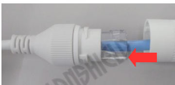
②RJ-45コネクタを差して防水キャップを取付けます。
