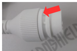
①カメラ側のコネクタにOリング取付け
