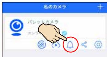
私のカメラ画面のベルアイコンを押すと、直接警報モードにジャンプします。斜線が入っていると動体検知は無効です。
