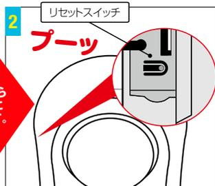
リセットボタンを約2秒間長押しするとインジケータランプが「早く(1秒間に約2回)」点滅をはじめ、「ブーツ」と音がします。
