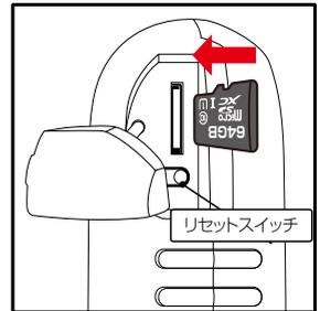
カメラ本体横のゴムの蓋を外します。SDカードを**図の向きで「カチッ」と**手応えがあるまで押します。
