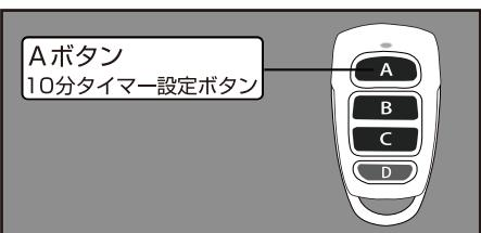
設定できるのは手動点灯時の点灯時間のみ
